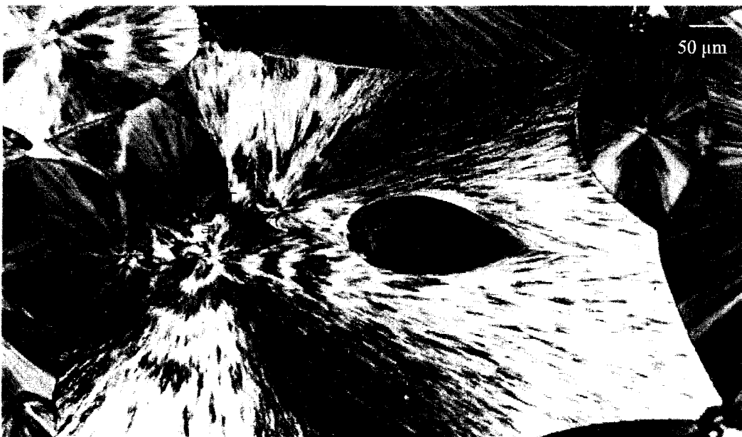
Figure I.13 : Limites intersphérolitiques curvilignes entre les sphérolites \alpha (sombres) et \beta (clairs). La plus grande vitesse de croissance de la phase \beta peut donner lieu à des morphologies sphérolitiques \alpha en 'goutte'.
