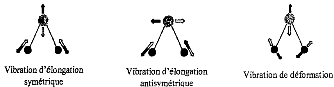
Figure B.II.4 : Représentation schématique des modes de vibration entre atomes d'une molécule triatomique non linéaire (ex : H_2O )
