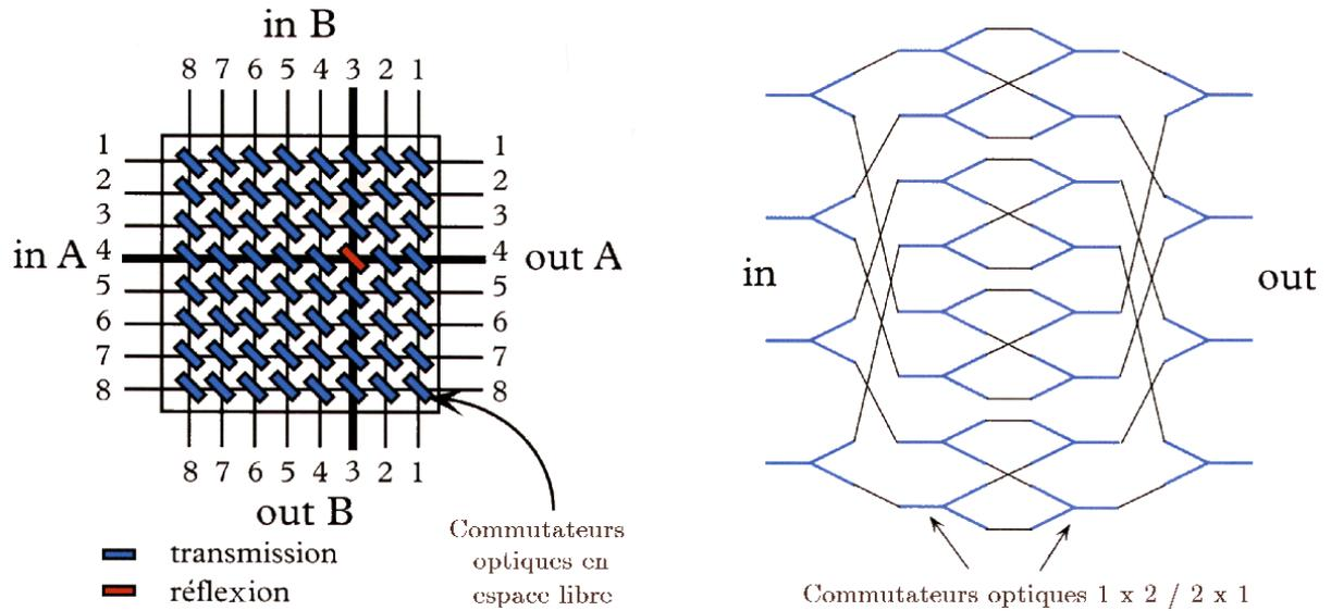
L'élément de base est le commutateur optique, les paramètres critiques sont la vitesse de commutation, les pertes, ainsi que la taille des composants.
