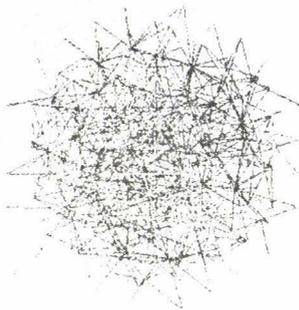
Figure III-17 : Maillage du VER simulant le matériau constitué d'amas de particules dans le composite.
