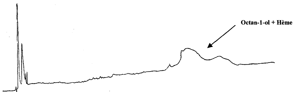
Figure 61. Profil chromatographique représentatif des phases organiques, issues de l'hydrolyse pepsique de l'hémoglobine dans le système biphasique tampon acétate de sodium 0,1 M pH 4,5 / octan-1-ol (50/50, v/v).
