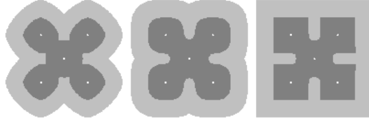
FIG. 1.3 – Objets calculés avec une distance D^n (a) n=1.5 , (b) n=3 , (c) n=\infty , images issues de l'article [BS95]
