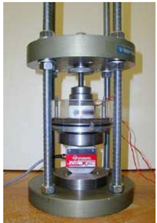
Figure II.2 Dispositif expérimental permettant de réaliser des essais à déformation axiale bloquée.
