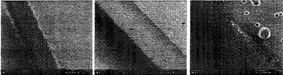
Figure 4.21 Ruban de polymère avec un masque d'or, puis retrait du masque et détail des flancs de gravure (de gauche à droite)
