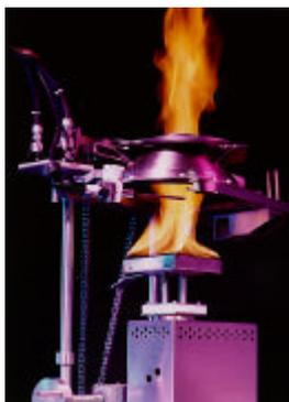
Figure I - 9: Calorimètre à cône.
