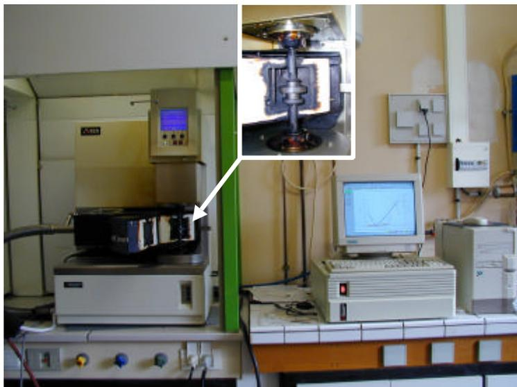
Figure IV - 2 : Rhéomètre Rheometric Scientific ARES-20A.
