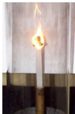
Figure I - 5 : Test LOI
