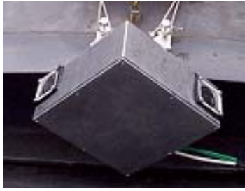
Figure 4.7. Boîtier contenant les deux caméras dos à dos.
