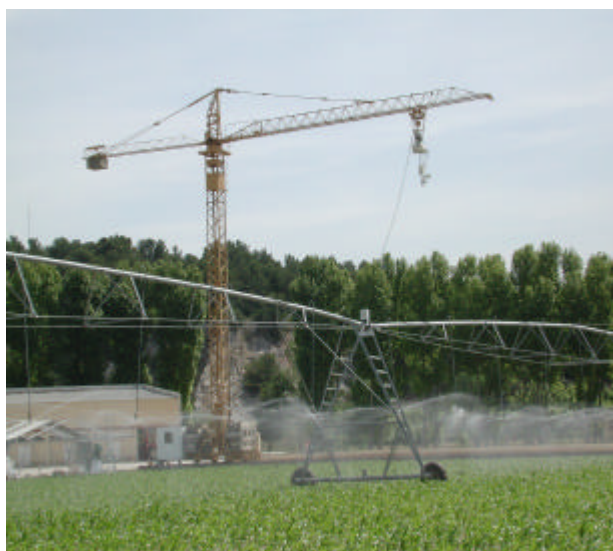
Figure 2.4 Le système de mesure: grue, plate-forme et caméra.
