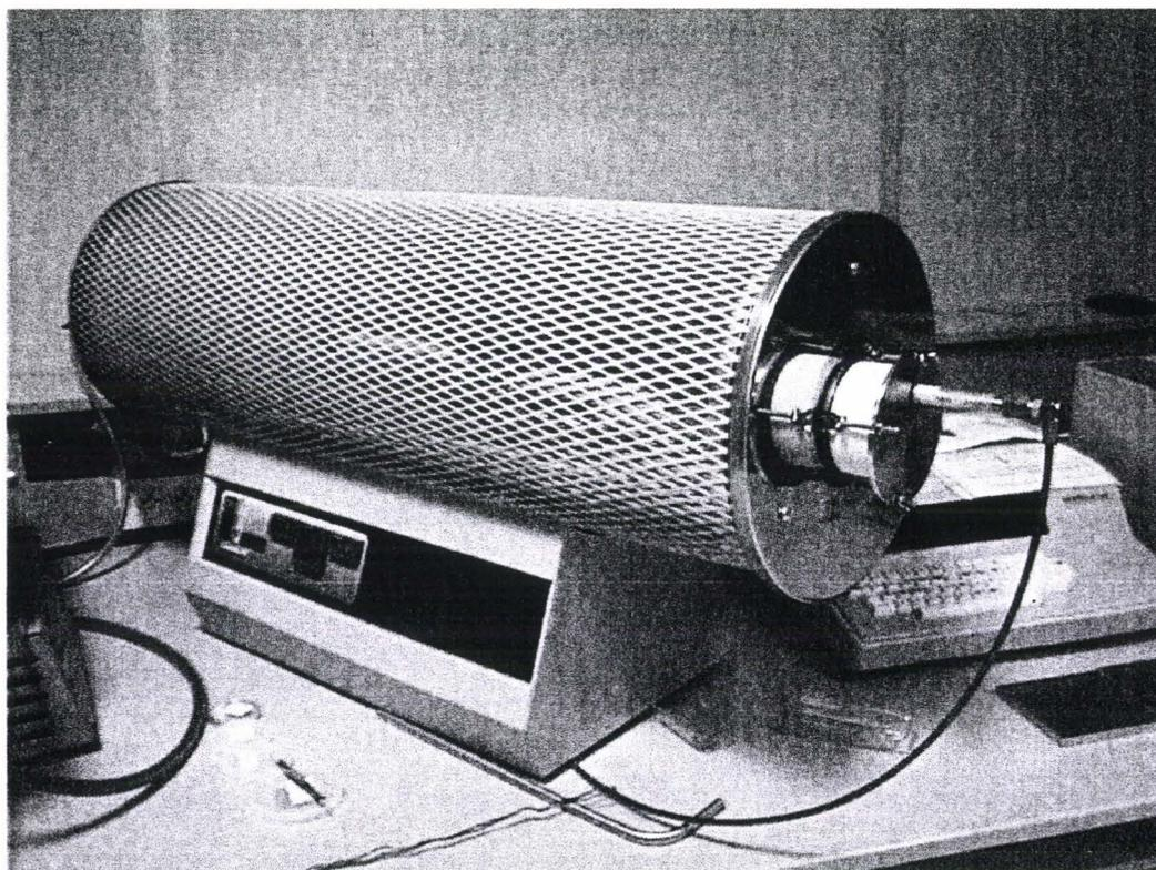
**Figure III. 59 : Four de recuit programmable Carbolite doté de programmeur 2416C avec circulation de gaz**
