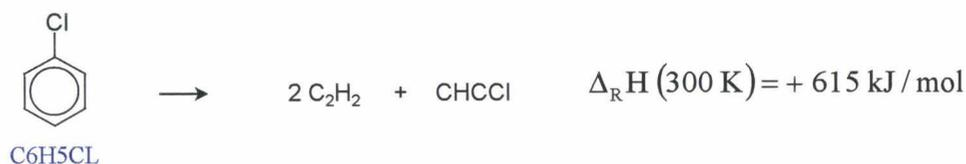
Figure IV.28 – Décomposition unimoléculaire du monochlorobenzène
