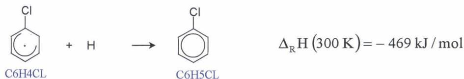
Figure IV.43 – Consommation du C<sub>6</sub>H<sub>4</sub>Cl – Formation du monochlorobenzène.
