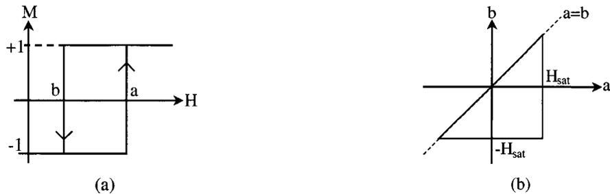
FIG. 2.15 - (a) commutateur magnétique (b) plan de Preisach.
