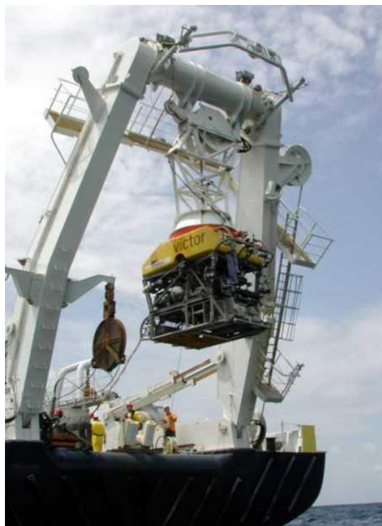
Figure 1. 13 : Photo du ROV Victor6000 pendant sa mise à l'eau depuis la plage arrière du Navire Océanographique l'Atalante (image Ifremer).
