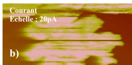
Figure II.28 : Imagerie en courant. En a) et b) image en topographie et en courant obtenue sur un grain de pentacène déposé sur une surface de \text{SiO}_2 . Les dimensions de l'image sont 3\mu\text{m} \times 1\mu\text{m} . La tension appliquée est de 5\text{V} , la vitesse de la pointe est de 0.5\mu\text{m/s} . En c) image en mode tapping de cordes d'ADN déposée sur une surface de polystyrène après une mesure électrique. On voit clairement que les brins sont abîmés par le passage de la pointe. La dimension de l'image est de 3\mu\text{m} \times 2\mu\text{m} .
