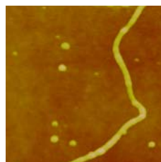
Figure II.25 : Image en mode tapping après une mesure de courant ponctuelle. La corde d'ADN est déposée sur une surface de polystyrène. La taille de l'image est de 1\mu\text{m} \times 1\mu\text{m} .
