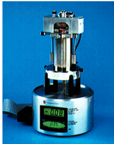
Figure II.01 : Principe de l'AFM. Des céramiques piezo-électriques servent à déplacer l'échantillon dans les 3 directions de l'espace. La surface de l'échantillon est scannée dans le plan Oxy en zig - zag. Le cantilever est composé d'un levier avec une pointe en son extrémité. Les déplacements du levier sont détectés par la réflexion d'un faisceau laser qui se réfléchit en son extrémité vers un détecteur. On représente dans les encadrés les différentes méthodes de détection du mouvement du levier. La technique la plus répandue est celle indiquée sur le schéma principal. Le signal ou une partie du signal reçu par le détecteur est comparé à un signal de consigne fixé par l'utilisateur. Le mouvement du piezo Z est ajusté de façon à minimiser la différence entre les deux signaux. L'appareil est représenté en mode oscillant. Le levier est excité à une pulsation proche de la résonance. Le signal recueilli par le détecteur est sinusoïdal. Dans le cas du mode contact, le cantilever n'oscille pas. Seule la flexion du levier est détectée.
