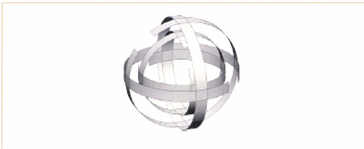
Fig. 23 : Isotropie impossible avec cette structure composée de trois paires de RAFs dont les axes sont orientés suivant les trois axes de l'espace mais ne présentant pas de fréquence de résonance car les rubans sont en contact.
