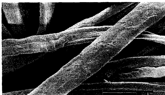
Figure 5 : Photo a : coton brut Photo b : coton greffé CTR/ \text{NaH}_2\text{PO}_4/\beta\text{CD} 10/3/10 170°C 5 min % CD 13,1.
