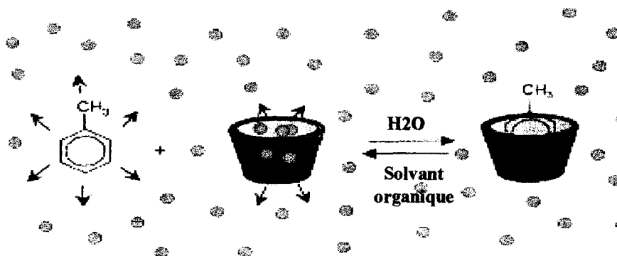
Figure 5 : Mécanisme d'inclusion du toluène en solution aqueuse par la cyclodextrine. Les flèches matérialisent les interactions entre le solvant l'eau et les régions hydrophobes du toluène.
