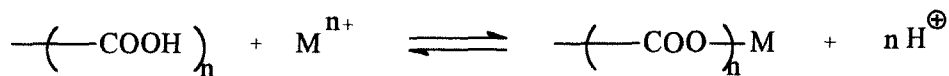
Figure 8 : Réaction de complexation entre les fonctions carboxyliques d'un support et un métal.
