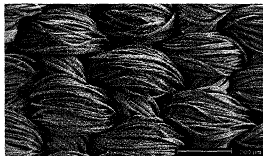
Figure 6 : Photo a : Polyester brut Photo b : Polyester greffé CTR/ \text{Na}_2\text{HPO}_4/\beta\text{CD} 10/3/10 210°C 5 min % CD 15,06.
