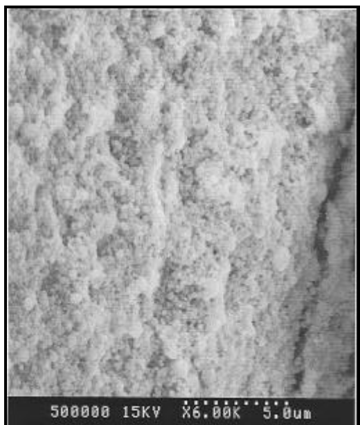
Fig. III.8 : Image par Microscopie Electronique à balayage du solide ( H_4/Cs_3H_{(2)} )
