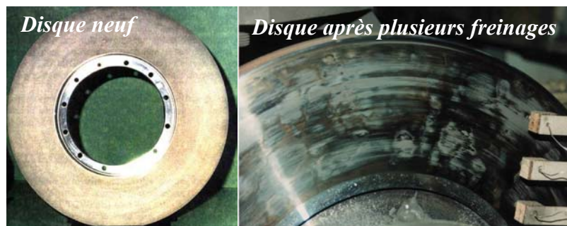
Figure III-26 : Disque avant et après plusieurs freinages
