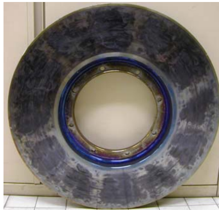
Figure I-2 : Points chauds sur un disque TGV
