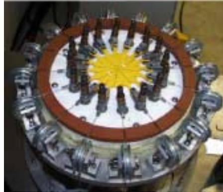
FIG. 2.15 – Traction équibiaxiale, sollicitation radiale d'un disque
