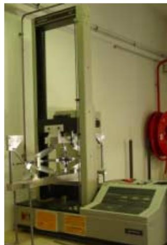
FIG. 2.20 – Système de traction biaxiale installé sur la machine de traction Instron 4302
