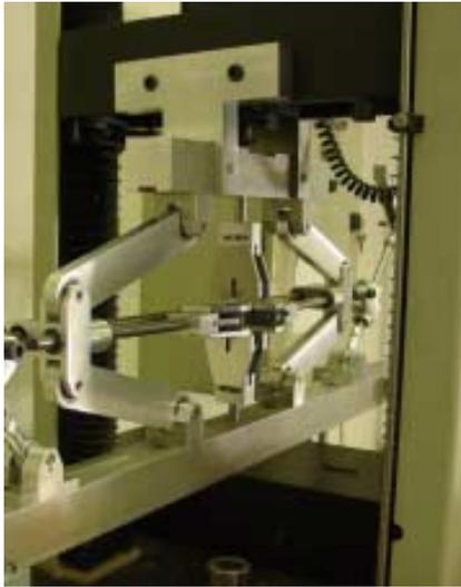
FIG. 2.21 – Fixation du système biaxial sur la machine de traction
