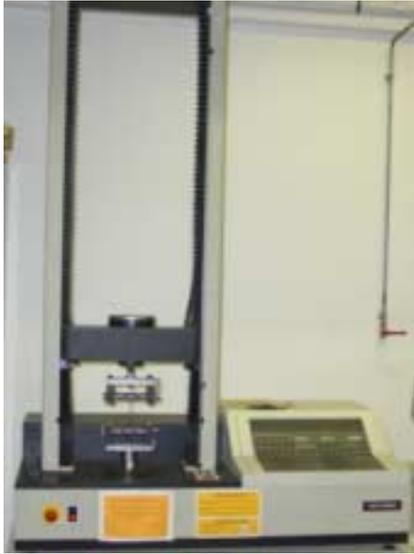
FIG. 2.2 – Machine d'essai utilisée pour les essais de traction uniaxiale cyclique
