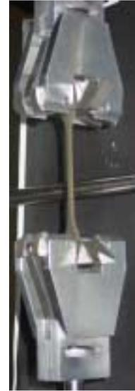
FIG. 2.3 – Mors autoserrants par un dispositif à excentriques pendant l'essai
