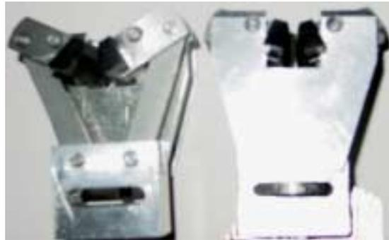
FIG. 2.4 – Mors autoserrants par un dispositif à excentriques
