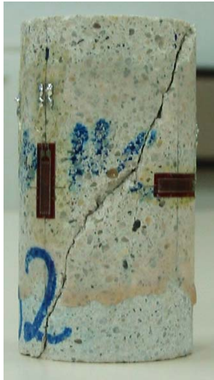
Figure A2.1 : Rupture en compression uniaxiale d'une éprouvette (protégée de la dessiccation) du mortier05.
