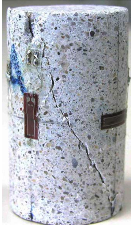
Figure A2.3 : Rupture en compression uniaxiale d'une éprouvette (en dessiccation) du mortier08.
