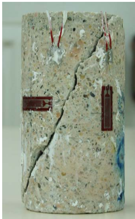
Figure A2.2 : Rupture en compression triaxiale d'une éprouvette (en dessiccation) du mortier05.
