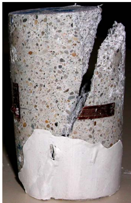
Figure A2.4 : Rupture en compression uniaxiale d'une éprouvette (en dessiccation) du mortier08.
