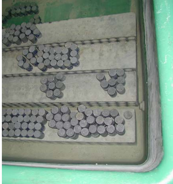
Figure 2.2 : Cuve thermostatée dans laquelle sont mises toutes les éprouvettes afin d'obtenir une maturité élevée.
