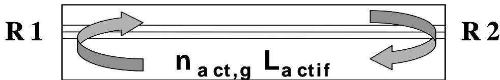
Figure 2-1: Schéma d'un résonateur optique de type Fabry-Pérot
