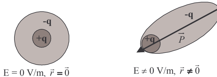
Figure II.6 : Déformation du nuage électronique d'un atome sous l'action d'un champ électrique
