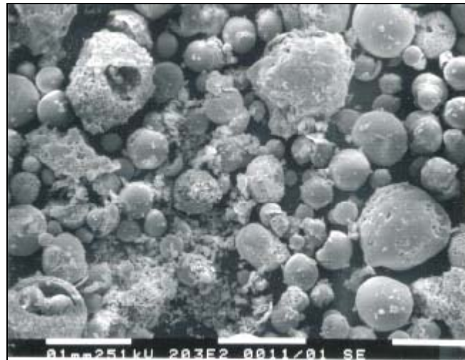
Figure 3.30 – Image SEM d'un échantillon de poudre de ZrB_2 projetée dans l'eau sous les conditions APS
