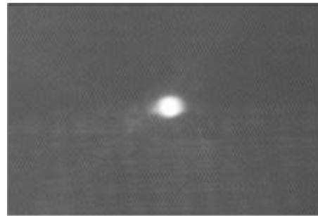
guide large de 5 µm avec un taper large de 10 µm.
