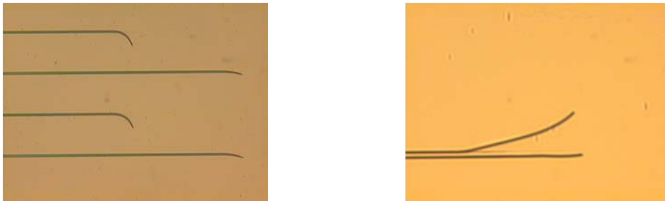
Figure IV-14 : Aspect des électrodes métalliques après la gravure chimique.
