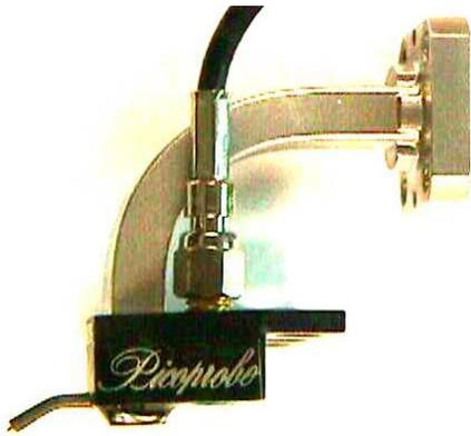
Figure 5 – Sonde à transition directe coplanaire guide WR28 et té de polarisation intégré
