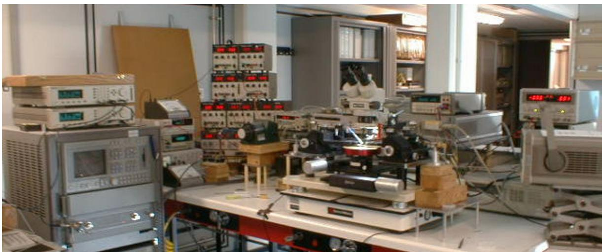
Figure 30 - Banc de mesure d'intermodulation 26 – 40 GHz
