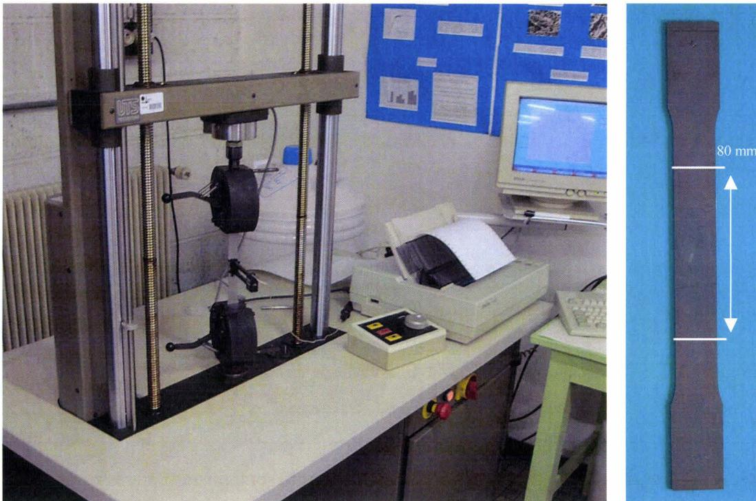
Figure 1. 2 – Machine de traction et éprouvette de traction  $A_{80}$ .
