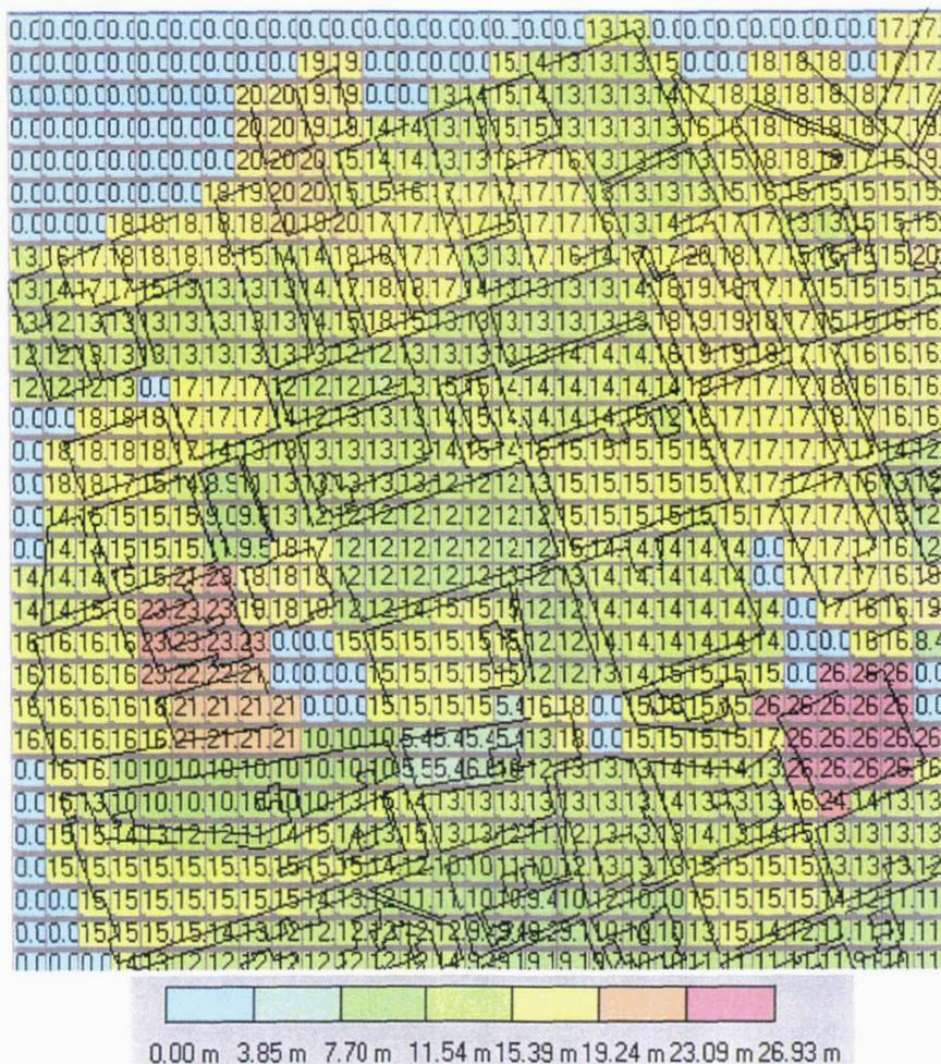
Figure 2-9: Hauteurs moyennes des bâtiments calculées par DFMap avec une résolution de 25 m\*25 m
