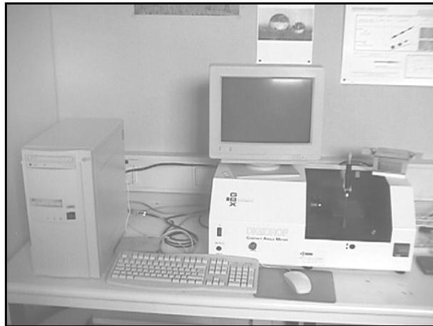
**Figure II.6.** Appareil de mesure DIGIDROP
