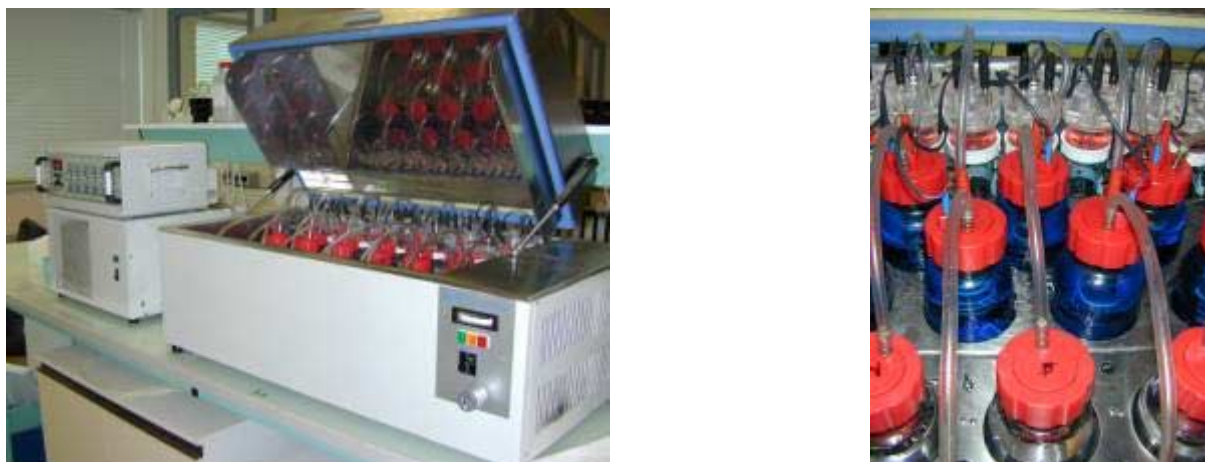
Figure 45 : Respirimètre. Liaison entre un réacteur, une cellule d'électrolyse et une électrode.
