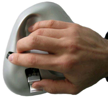
FIG. 4.18 – Placement de la main sur le DigiHaptic.
