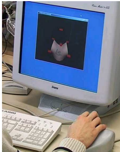
FIG. 3.4 – Contrôle en position du pointeur avec retour de force sous Spore.
