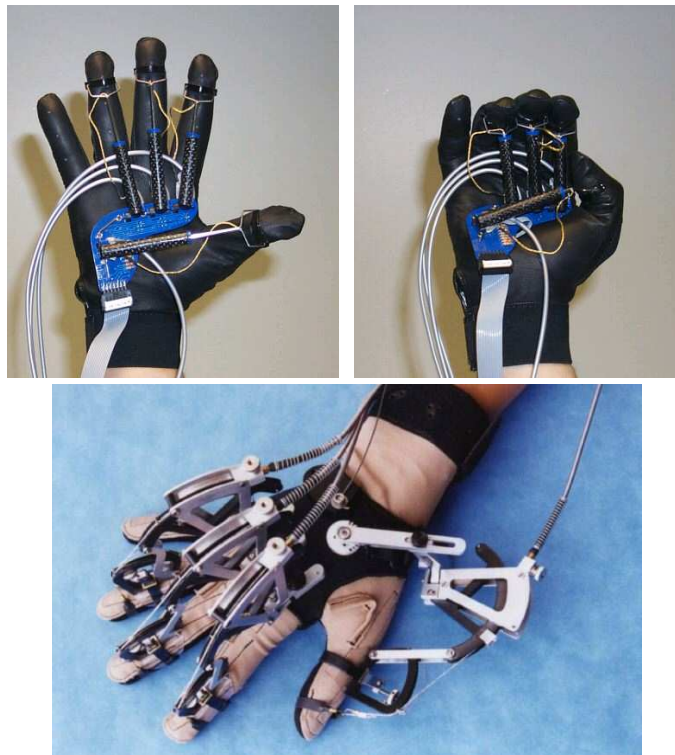
FIG. 1.9 – Gants Rutgers et le CyberGrasp
