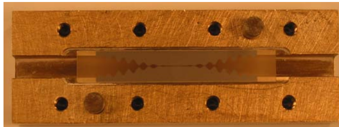
FIG. 2.31 – Transition filtrante insérée dans la rainure du guide WR42.
