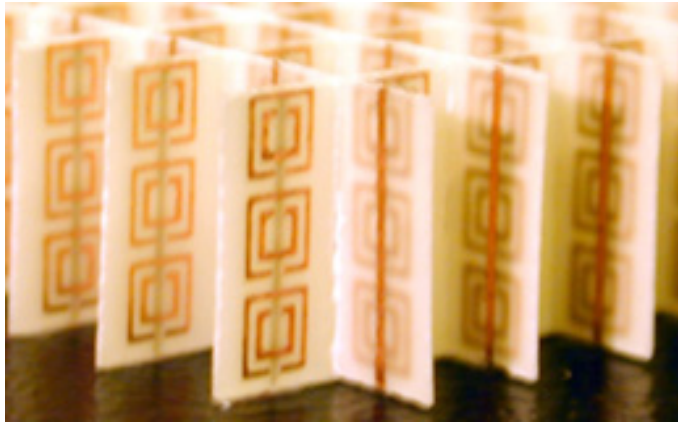
FIG. 3.19 – Photo du milieu composite 2D réalisé par R. A. Shelby [124].
