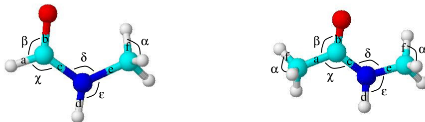
figure 19 : Représentations des molécules de NMF ( \text{HCO-NH-CH}_3 ) et de NMA ( \text{CH}_3\text{-CO-NH-CH}_3 ), et des distances et angles permettant de calculer toutes les distances intramoléculaires. Les distances indépendantes sont indiquées par les lettres de a à f, et les angles indépendants par les lettres grecques de \alpha à \epsilon .
