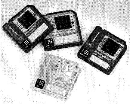
Figure 21 : Puces LabChip développées conjointement par les sociétés Caliper et Agilent Technologies pour des analyses d'ADN (bleu), ARN (vert), de protéines (mauve) et de cellules (jaune).
