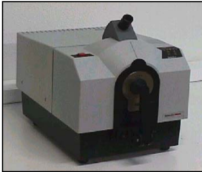
Figure 2.12. Spectrophotomètre SF600 PLUS
