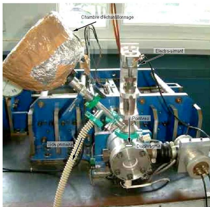
Figure 3.3 : Dispositif de prélèvement de la MCR.
