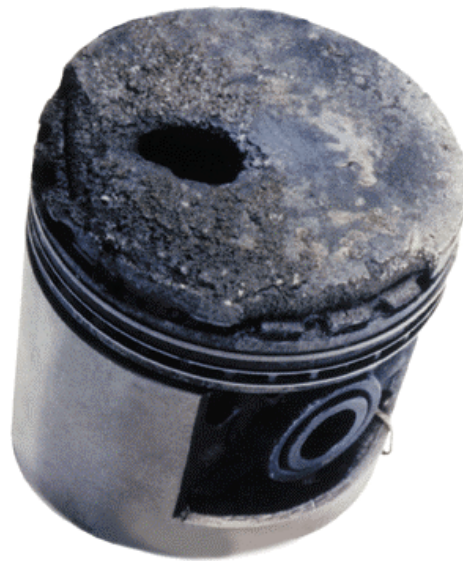
Figure I.2 : Exemple de piston endommagé par le cliquetis [2].
