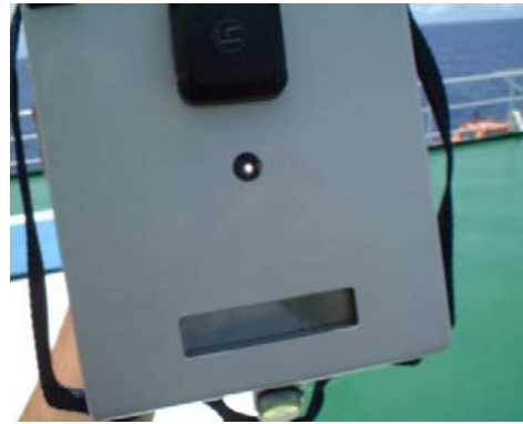
Figure a1-3. Image de la tâche solaire dans le hublot du SIMBADA pendant l'enregistrement d'un fichier SUN.
