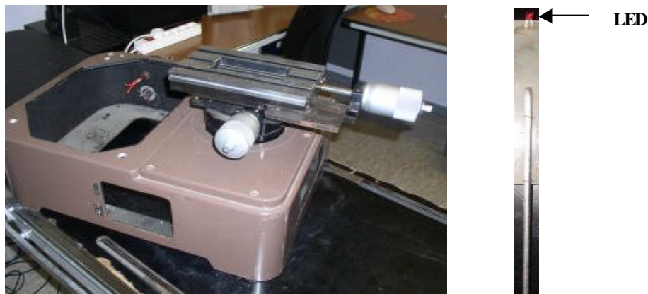
Figure 2. 19 : Banc micrométrique et stylo optique équipé de LED
