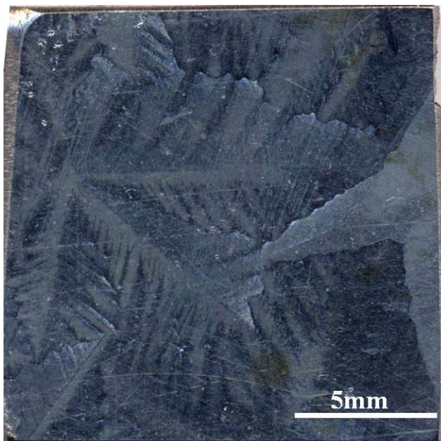
Fig. I.3 : Structure en fleur d'un revêtement galvanisé à chaud Fig. I.3 : Typical spangle structure of a galvanized coating.
