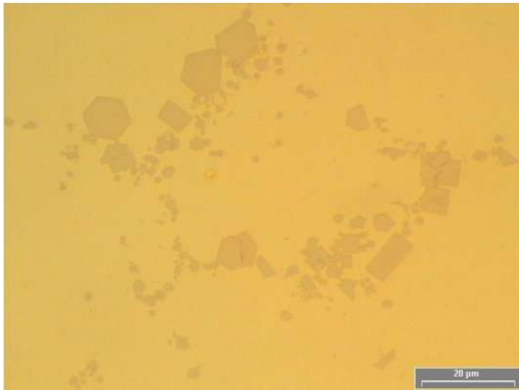
Fig. II.22 : Précipitation des mattes \tau_1' aux joints de grains.
