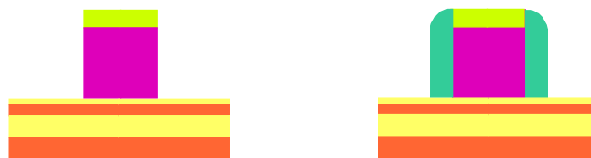
Fig. III.25: Représentation schématique de la grille en tungstène surmontée d'une couche de protection (gauche) et de la grille dite encapsulée après formation des espaceurs (droite).
