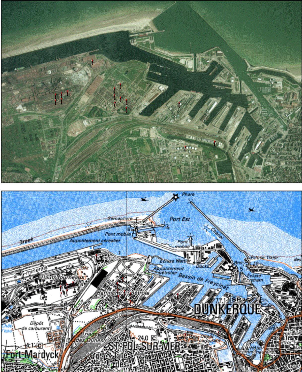
**Figure 2-2.** Outils de géoréférencement des grandes sources ponctuelles : photographies aériennes (*haut*) et cartes numérisées IGN au 1/25 000 (*bas*). Exemple du port autonome de Dunkerque où sont distingués une usine sidérurgique (à l'ouest), une raffinerie (au centre), et des dépôts de carburants (à l'est).
