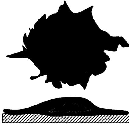
*Fig. 6.15 Morphologie de la particule de HA à l'impact sur la surface du substrat : la vue d'en haut et la section*
