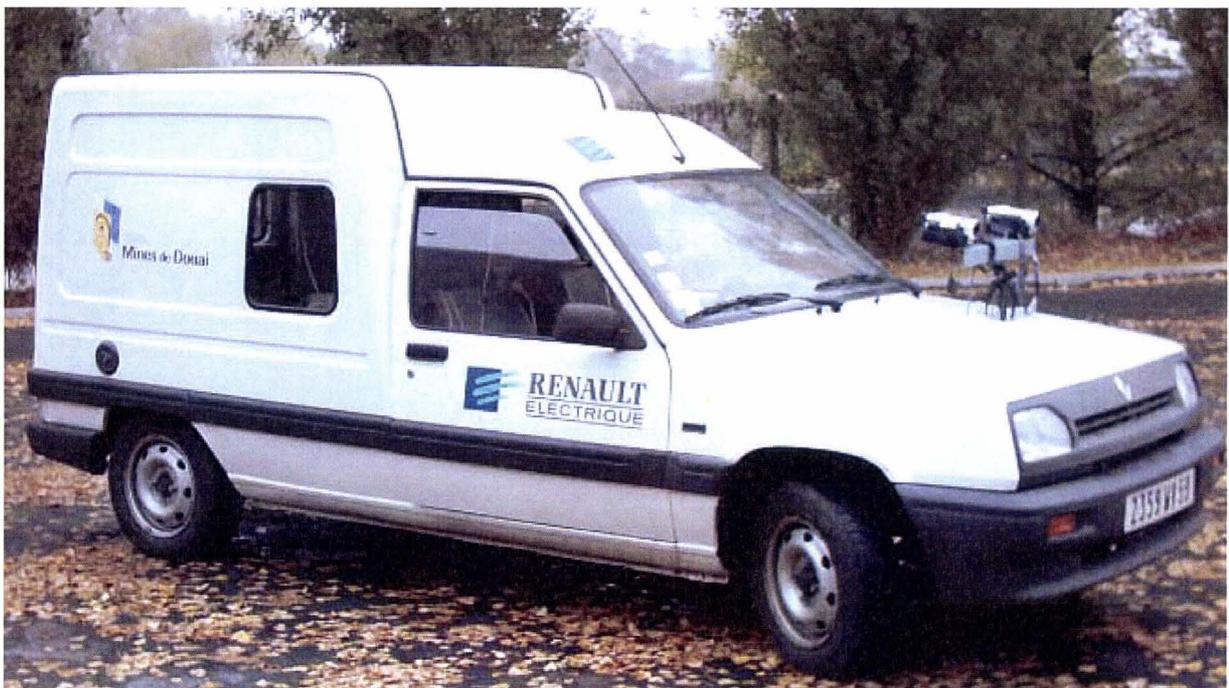
**Figure.III.51 :** Le véhicule électrique expérimental de l'école des mines de douai, équipé d'une tête stéréo montée sur son capot et d'une unité de traitement embarquée.
