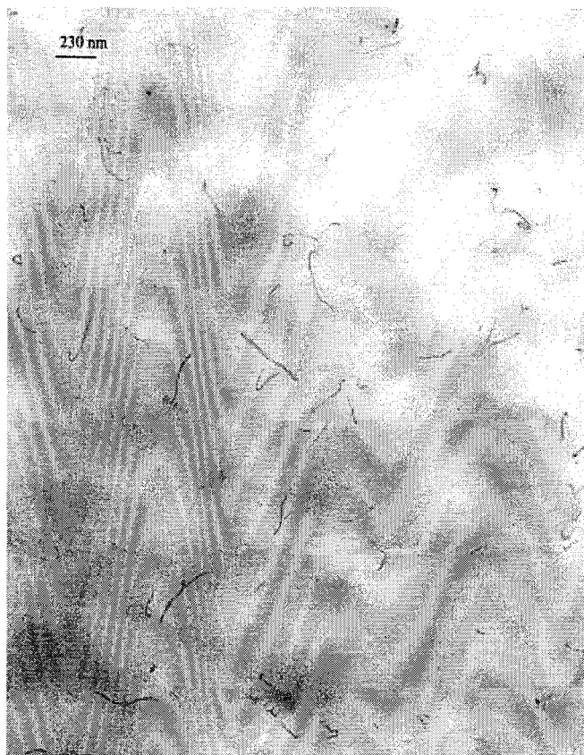
Figure 40. Image TEM des MWNT dans la matrice PPgAM.
