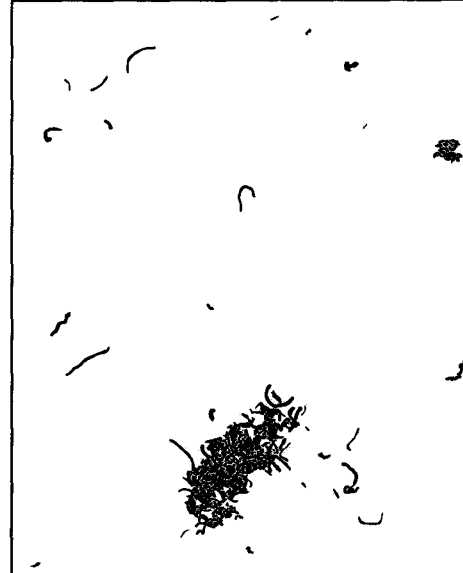
Figure 71. Image TEM de 0.5 % de MWNT pur dans une matrice polymère polystyrène après binarisation.
