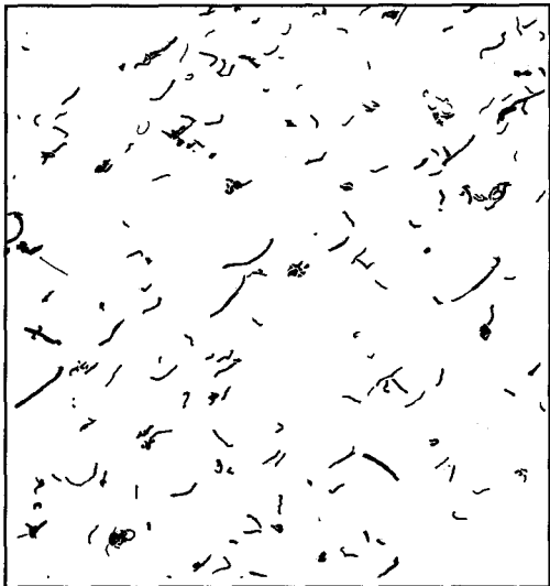
Figure 78. Image TEM de 0,5 % de MWNT modifiés (1:1) DMHDI-TFB dans une matrice polymère PS.
