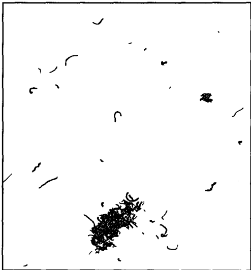
Figure 77. Image TEM de 0,5 % de MWNT non modifiés dans une matrice polymère PS.
