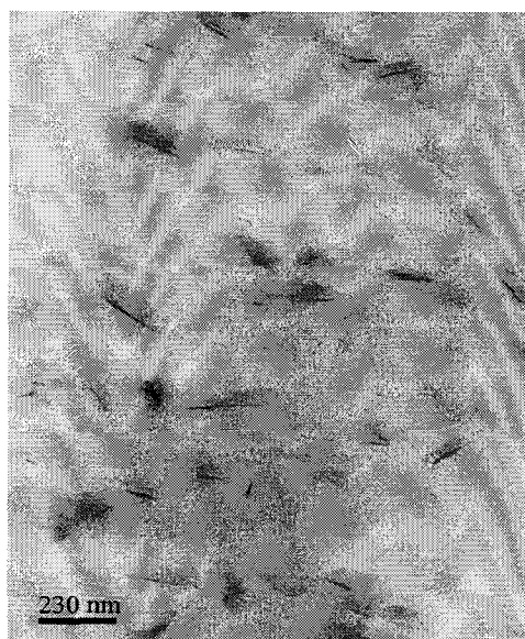
Figure 28. Image TEM du mélange PET/2%Cloisite 30B à faible grossissement.
