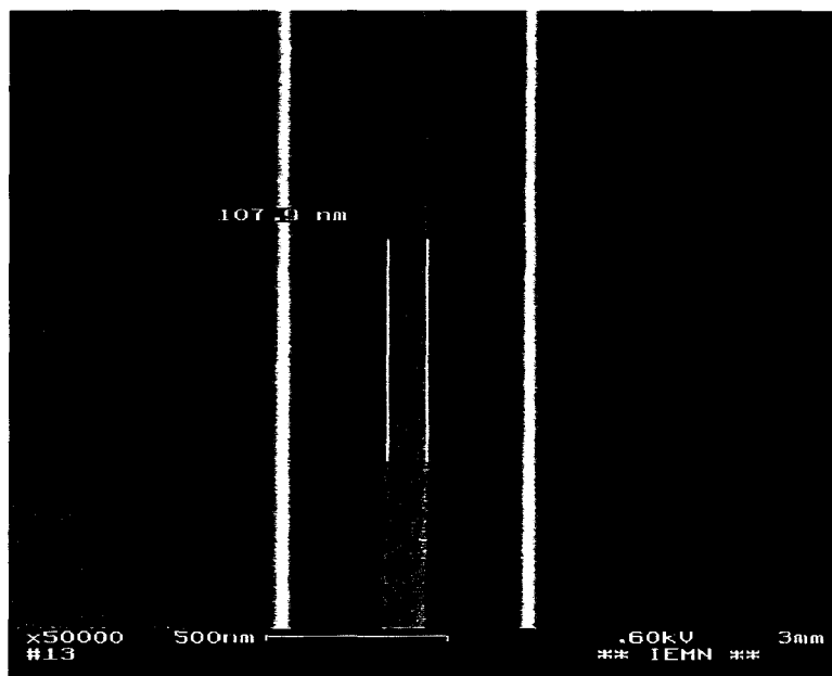
Figure II-12 : Observation MEB de la lithographie de grille 100nm après révélation.
