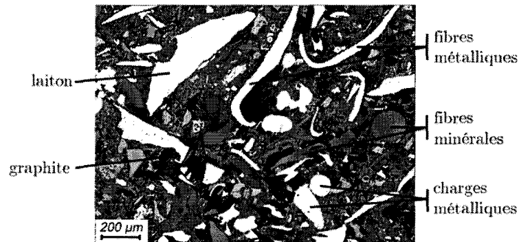
figure II.13 : Microstructure du composite à matrice organique après polissage.
