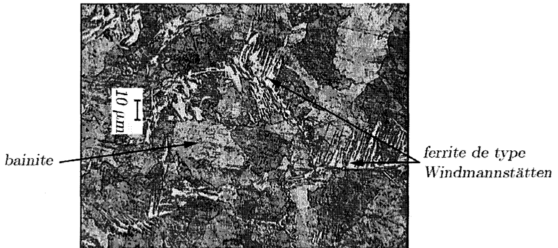
figure IV.23 : Structure métallurgique initiale de l'acier C45 utilisé
