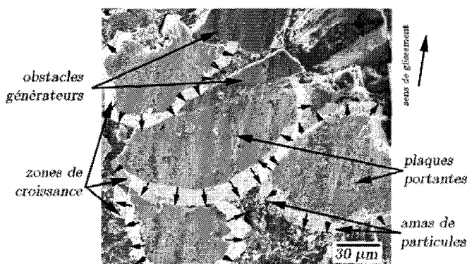
figure V.22 : Coalescence de plaques portantes voisines
