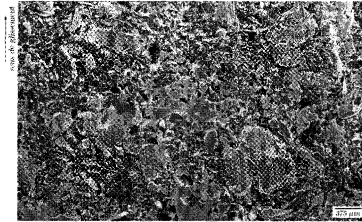
figure V.78 : Surface majoritairement recouverte de zones portantes à la surface du patin-secteur Fi_{60}
