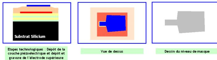
Fig. 4.8: Troisième suite d'étapes technologiques pour la réalisation des résonateurs de type SMR
