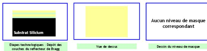
Fig. 4.6: Première suite d'étapes technologiques pour la réalisation des résonateurs de type SMR
