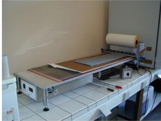
Figure II - 21 : Table à enduction K404 Control Coater.
