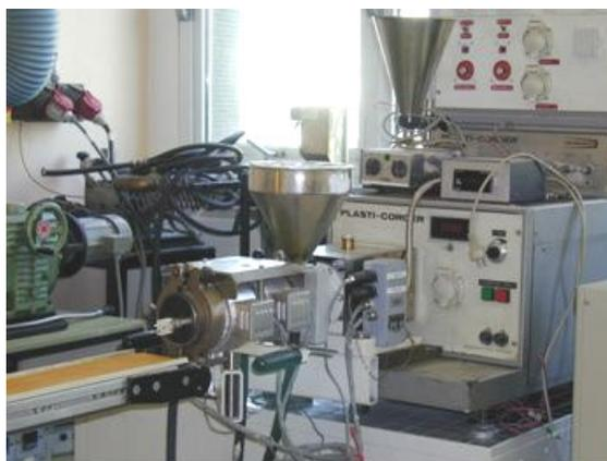
Figure II - 39 : Extrudeuse bi-vis contrarotatives de Brabender.
