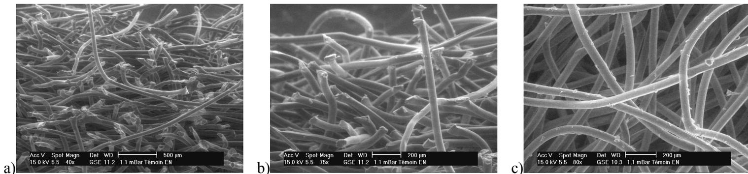
Figure II - 31 : Images obtenues au MEBE du non-tissé de PP vierge (a et b : coupe, c : face dense).
