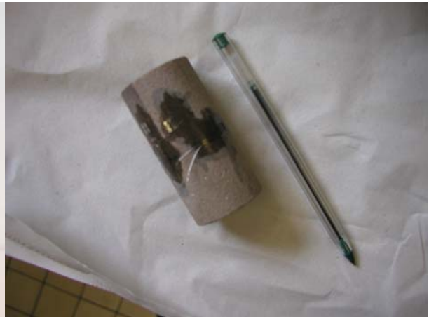
Figure VIII. 2 : des éprouvettes instrumentées avec des jauges
