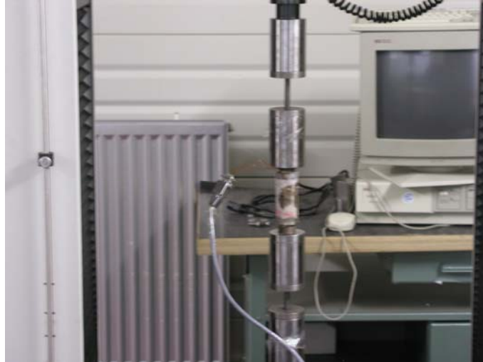
Figure VIII. 3 : la montage d'essais de traction
