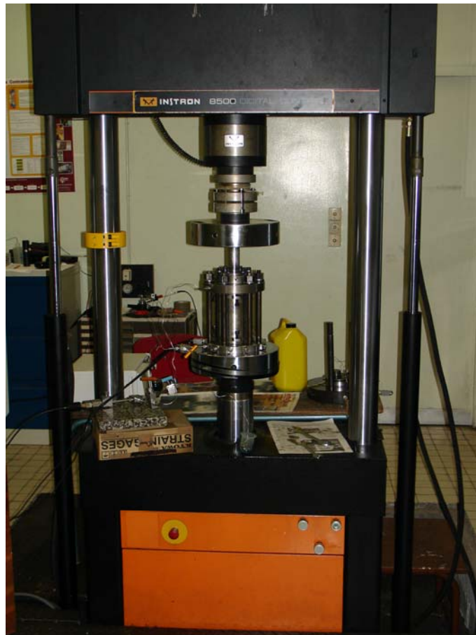
Figure VIII. 3 : la montage des essais de compression A) un essai de compression simple B) une éprouvette montée sur la cellule triaxiale C) la presse hydraulique de triaxial
