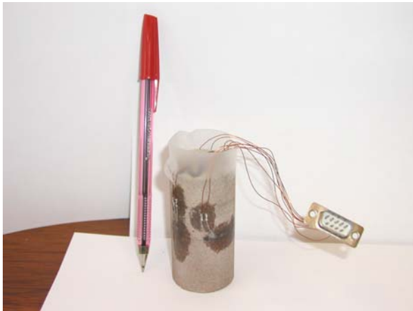
Figure VIII. 2 : des éprouvettes instrumentées avec des jauges
